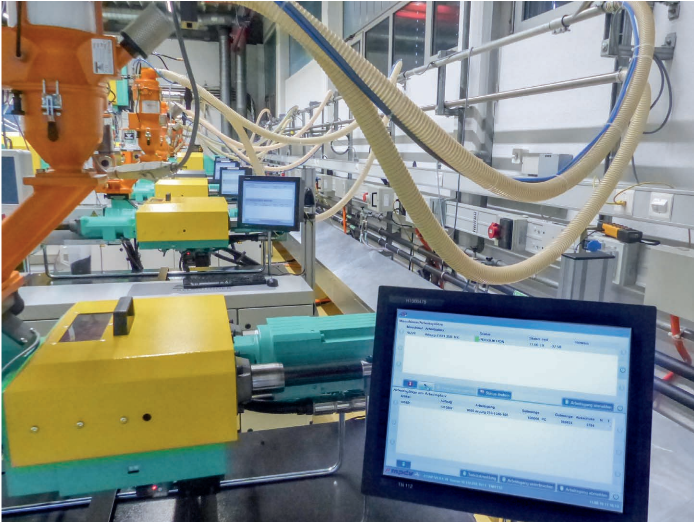
Fällt eine Maschine aus, sehen Mitarbeiter von Sulzer Applicator Systems das sofort an ihren Terminals und können gezielt gegensteuern.
